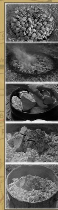
Pendant trois jours et trois nuits, on devait maintenir une température de 1000 degrés pour transformer la pierre en chaux vive. En calcinant le carbonate de calcium (la pierre calcaire) laisse échapper la gaz carbonique et devient la chaux vive (oxyde de calcium).
