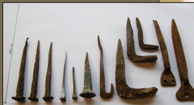
De g. à d.: 3 clous forgés à la main, charpente de la chapelle de Blindeff; 2 clous à ferrer forgés à la main, forge Pirnay à Louveigné ; 1 clou à marquer avec la marque sur la tête et des crochets forgés à la main.
